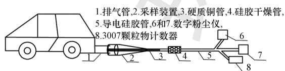
图 1 机动车尾气颗粒物测量实验装置
